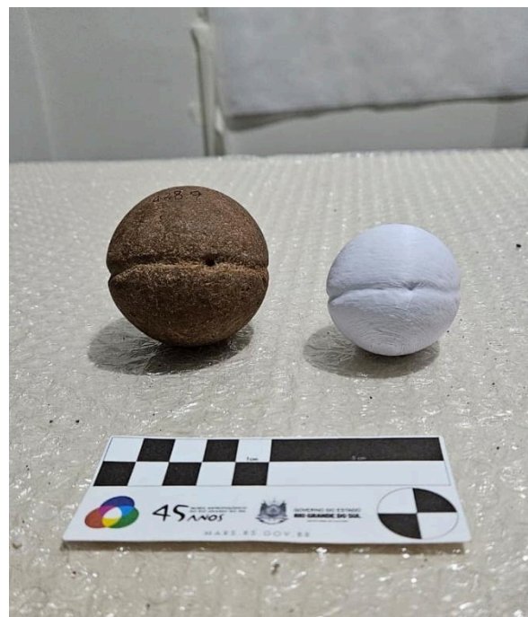
Figura 4 - Reprodução de bola de boleadeira em ácido polilático (PLA)
