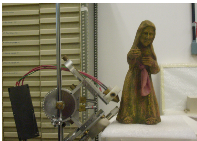
Figura 3 – Em (a) foto do sistema de EDXRF na medida em um dos pontos analisados da escultura 0929; Em (b) espectro de energia de raios X característicos relativos ao ponto medido.
